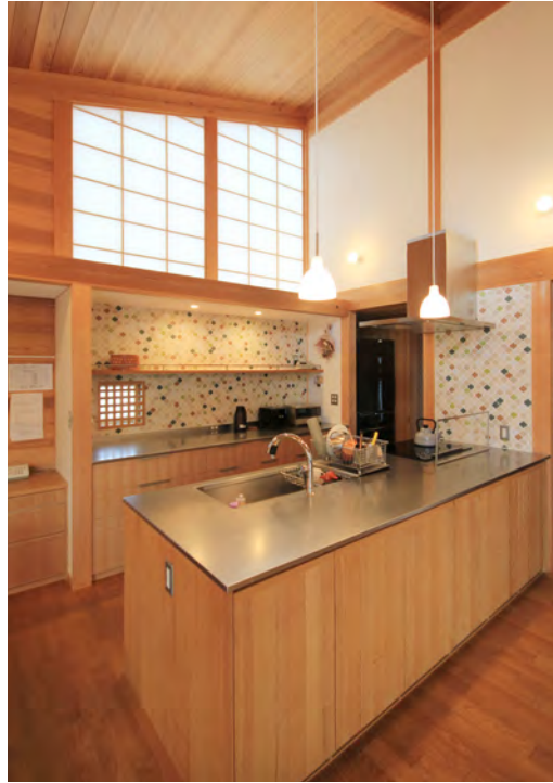
キッチン 二の字型のアイランドキッチン。広く大きなステンレスカウンターが特徴で、家族みんなで料理を楽しめるキッチン。IHヒーターの前には油跳ね防止のガラス仕切りを設けた。壁タイルは名古屋モザイクのコロベル。
